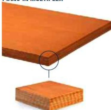
I piani in multiplex sono formati da più strati di faggio, piallati, incollati e pressati tra di loro. In questo modo formano un piano indeformabile e resistente ai carichi e all'usura.
